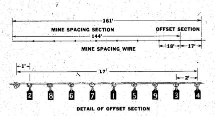
Figure 32.03. Mine-spacing wire.
